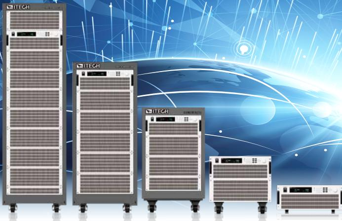
IT8900A/E系列大功率直流电子负载，具有150V、600V、1200V三种电压范围，单机功率从2kW到54kW。较宽的电压电流范围，独立主机控制，通过主从并联，最大功率可扩展到600kW。高功率密度，6kW仅4u高度。
